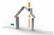
Systeem C natuurlijke toevoer, mechanische afvoer
