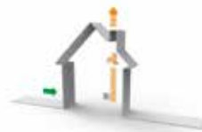
Systeem C+® (EVO) natuurlijke toevoer, vraaggestuurde mechanische afvoer
