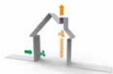
Systeem D mechanische toevoer, mechanische afvoer
