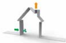
Systeem B mechanische toevoer, natuurlijke afvoer
